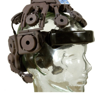
(d) Dry electrodes DSI-24 headset
